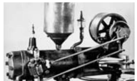
Detailní pohled na ležatý čtyřtákní jednoválcový motor, který poháněl tříkolku z roku 1886.
